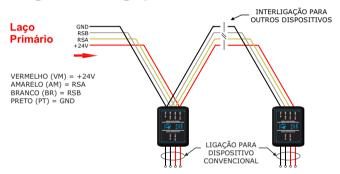
OBS.: Na configuração Classe B, a ligação finaliza no último dispositivo instalado.
