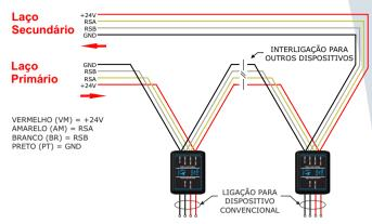
OBS.: Na configuração Classe A, após a instalação do último dispositivo, a ligação deverá retornar para central.
