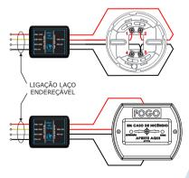
OBS.: Para conexão correta, o fio vermelho deverá entrar no dispositivo e sair retornando para o outro lado do módulo conforme diagrama.
